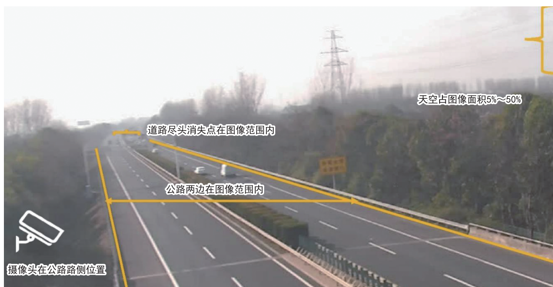
图 A.2 摄像头在高速公路路侧位置符合取景要求的画面示意图
