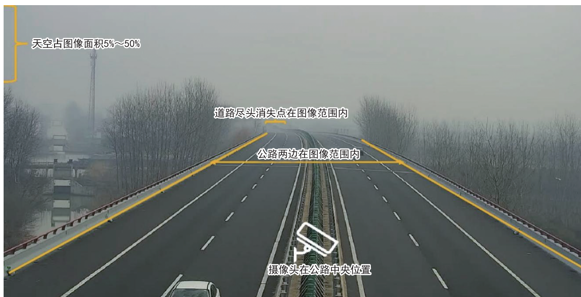
图 A.1 摄像头在高速公路中央位置符合取景要求的画面示意图
